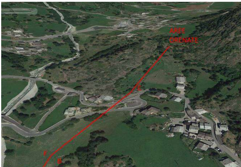
Figura 6 - Tracciato esistente acque di scarico
